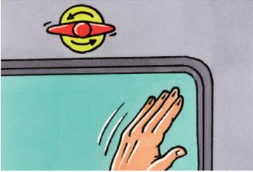
Neben den Ausstiegstüren befinden sich deutlich sichtbare Nothahnen. Bei Gefahr sind diese in Pfeilrichtung zu drehen. Die Tür lässt sich danach manuell aufstossen. Falls Ihnen dies nicht alleine gelingt, bitten Sie Mitreisende um Hilfe. Auch Dachluken können als Notausstiege genutzt werden.
