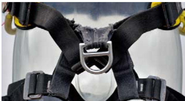
2 Ce harnais fortement endommagé doit être remplacé (de plus ce n'est pas un harnais complet selon EN 361).
