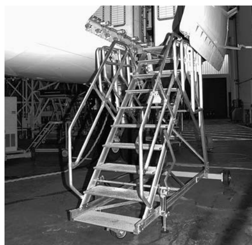
2 Gegen Verschieben gesicherte Wartungstreppe mit heruntergeklappten Geländerteilen
